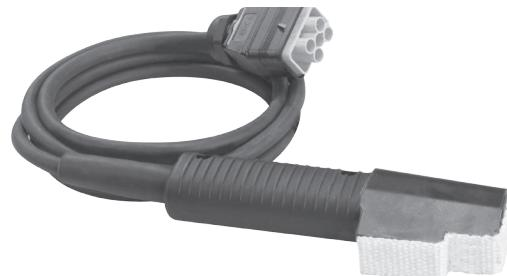
Der Bolzen-Induktor wird zum Aufheizen korrodiert oder festsitzender Teile wie Schrauben, Bolzen oder Muttern angewendet. Für diesen Zweck sollte das Gerät auf maximale Ausgangsleistung eingestellt werden. Der Induktor kann auch zum Entfernen von Dichtungsmaterial oder Dämmfolien an LKW-Chassis oder beispielsweise Kofferraumböden bei PKW genutzt werden. Außerdem eignet er sich zum Verlöten von größeren elektrischen Steckverbindern und zum Formen von Blech- bzw. Metallteilen.
