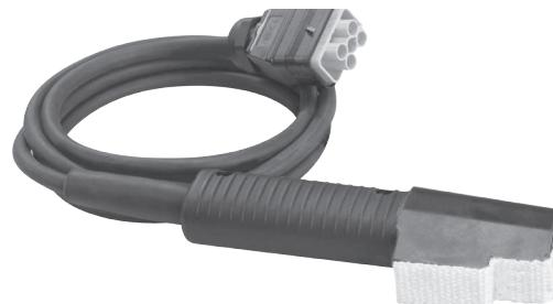
El inductor para desbloqueo se utiliza para un calentamiento intenso de las partes oxidadas o bloqueadas como tuercas o pernos. Cuando el inductor se utiliza para desapretar tuercas o pernos bloqueados, conviene utilizar la potencia máxima desde el principio. Este inductor se puede utilizar igualmente para quitar el calafateo de los chasis de camiones o de los maleteros de vehículos y para la soldadura de grandes conectores o moldeado de metal.
